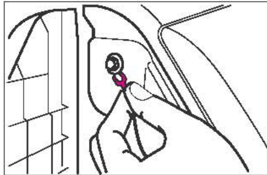
5. 상시전원케이블을 퓨즈박스에 연결합니다. (노란배선은 상시전원이 나오는 퓨즈에 빨간배선은 ACC전원이 나오는 퓨즈에 연결하세요.)
